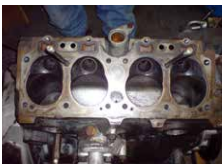
Oben links: 1595ccm Siamese-Motorblock ohne Kühlmittelkanäle zwischen den Zylindern. Rechts: 1997ccm Motor, aufgebohrte Version, auch ohne Kühlmittelkanäle! Unten: Kühlmittelkanäle in der «spread-bore-engine»
