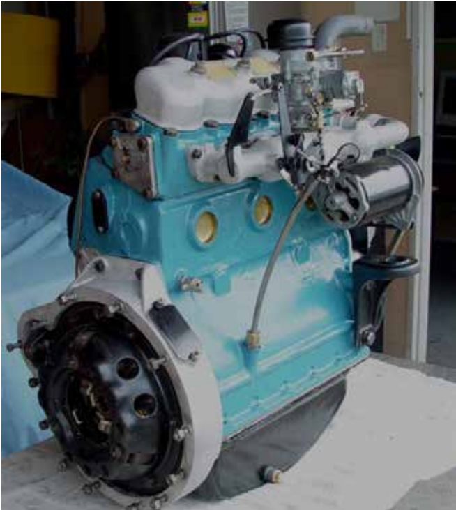
Ansicht eines Motors mit den runden Alu-Deckeln am Block und dem langen Ölmesstab.
