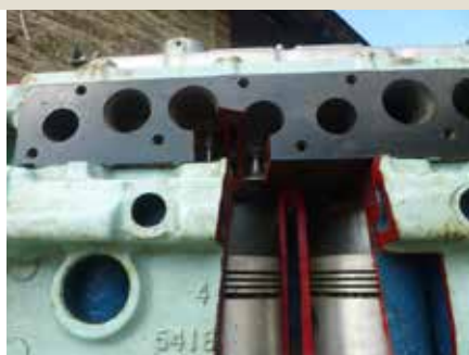
Oben links: 1595ccm Siamese-Motorblock ohne Kühlmittelkanäle zwischen den Zylindern. Rechts: 1997ccm Motor, aufgebohrte Version, auch ohne Kühlmittelkanäle! Unten: Kühlmittelkanäle in der «spread-bore-engine»
