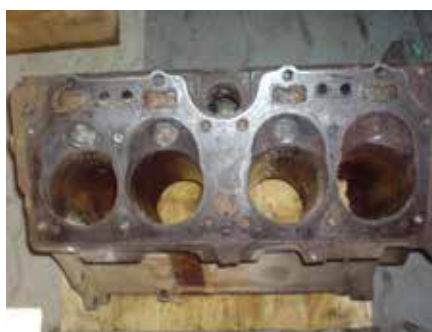
Oben links: 1595ccm Siamese-Motorblock ohne Kühlmittelkanäle zwischen den Zylindern. Rechts: 1997ccm Motor, aufgebohrte Version, auch ohne Kühlmittelkanäle! Unten: Kühlmittelkanäle in der «spread-bore-engine»
